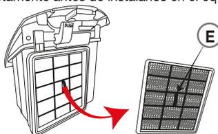
**Filtro HEPA entrada de aire:** Extraiga el contenedor de polvo presionando el botón A y retire el filtro E.
