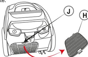
**Filtro salida de aire:** Presione la traba J y retire el filtro como se muestra en la imagen. Realice el proceso inverso para colocarlo nuevamente.
