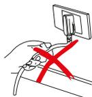
No tire del cable para retirar el enchufe de la red eléctrica.
